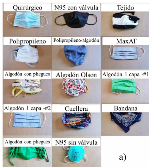
Figura 6.1.1. a) Fotografías de los dispositivos tapabocas utilizados. b) Cantidad de gotas relativa a la emitida por el hablante sin tapabocas. C: cinta de polipropileno, N: nada. Adaptado de [56].
